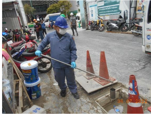
รูปที่ 3.4-8 การเก็บตัวอย่างคุณภาพน้ำทิ้ง
